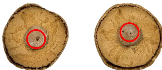
พบรูฟองอากาศที่ไส้ หรือสpongจขนาดไม่เกิน 0.5 cm
